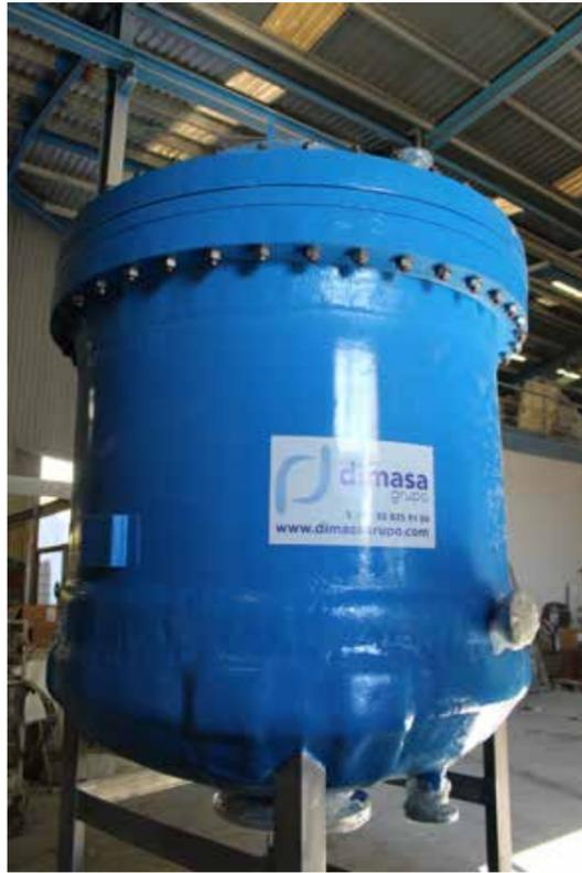
Las carcasas presurizadas para filtros de cartucho de **Dimamex** tienen un óptimo comportamiento para filtrar aguas con **diferentes grados de salinidad**, para obtener un mayor grado de **protección en las membranas de ósmosis**.
