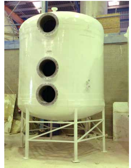
Tanque con filtración de arena vertical
