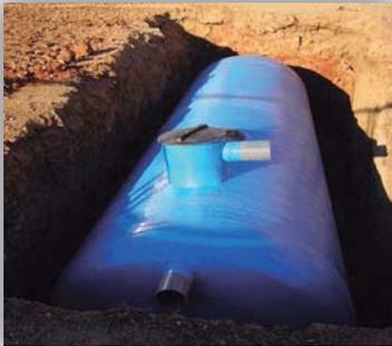
Los compactos SBR basados en el mismo principio tecnológico que los compactos DOT de aireación prolongada pero en un solo compartimento. En la misma cámara secuencialmente airea y decanta.
