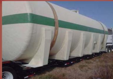
Dos fondos toriesféricos, aros de refuerzo en PRFV y cunas en PRFV o en acero al carbono.
