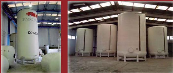
Tanques verticales de superficie con fondo inferior torisférico y superior torisférico, plano o abierto.
